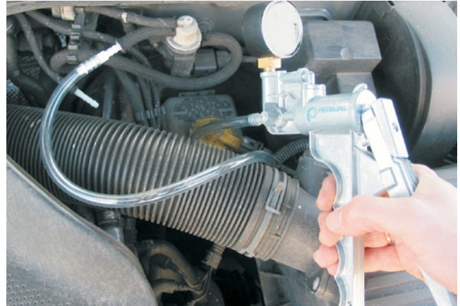
Kontrola przetworniki ciśnieni przy użyciu ręcznej pompy podciśnieniowej (VW Golf IV) (Pierburg Numer artykułu 12 00001 11 900)
